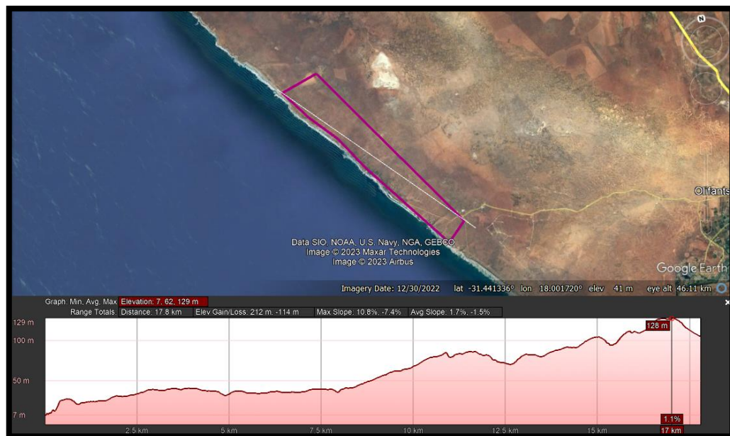
Figuur 9: Vertikale profiel van die voorgestelde prospekteringsvoetspoor (Foto verkry van Google Earth).
